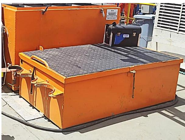
Figura 2.2. O espaço mais adequado para alocação das “caixas” com as bombas para acompanhamento e avaliação dos resultados está localizada junto à popa da embarcação próximo ao pórtilo de lançamento dos mergulhadores. O espaço possui dimensões de 1,70 metros de comprimento X 70 cm de largura e fica a aproximadamente 50 cm do chão do deck. Nesta área existe uma lona que poderia ser esticada, fornecendo sombreamento ao local.
